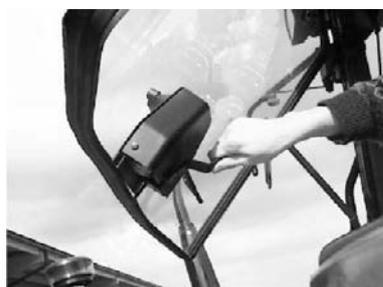
Le tracteur est équipé d'une porte avant ouvrable. Pour l'ouverture, tourner le levier dans le sens inverse des aiguilles d'une montre. Deux ressorts à gaz maintiennent en position entrebâillée la porte une fois poussée en avant.
