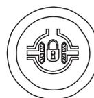
Le blocage intervient sur actionnement de la commande électrohydraulique: pour actionner le blocage pousser le bouton (représenté sur la figure) la lampe incorporée du témoin s'allume aussi longtemps que le bouton est pressé.
