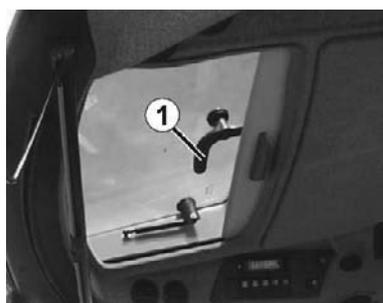
Le toit de la cabine dispose d'une large surface vitrée pour permettre le contrôle de la manoeuvre des chargeurs frontaux.
