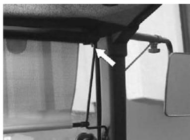
En le baissant, il s'arrête automatiquement dans la position désirée. En poussant le bouton rouge à droite du support, le rideau s'enroule automatiquement.
