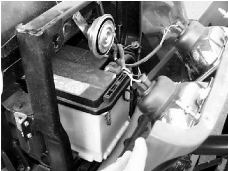
3 - Desserrez les 2 vis de fixation de la bride de fixation de la batterie et déposez la batterie.
