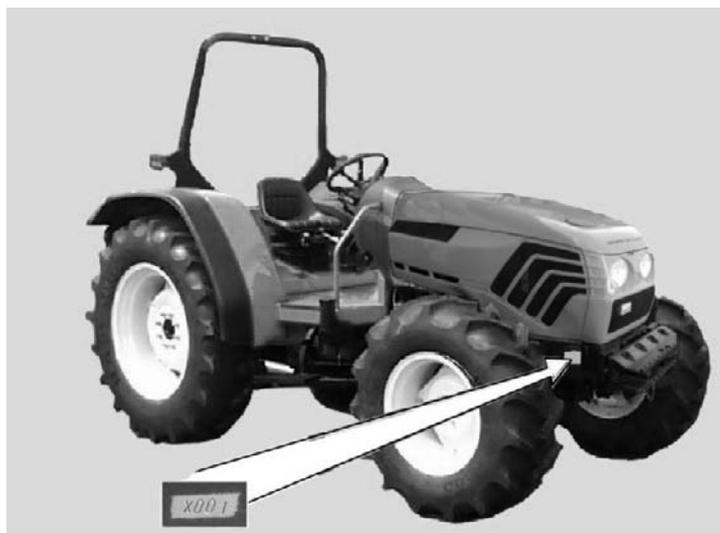
Le numéro de série du moteur est gravé sur le côté droit du support avant.
