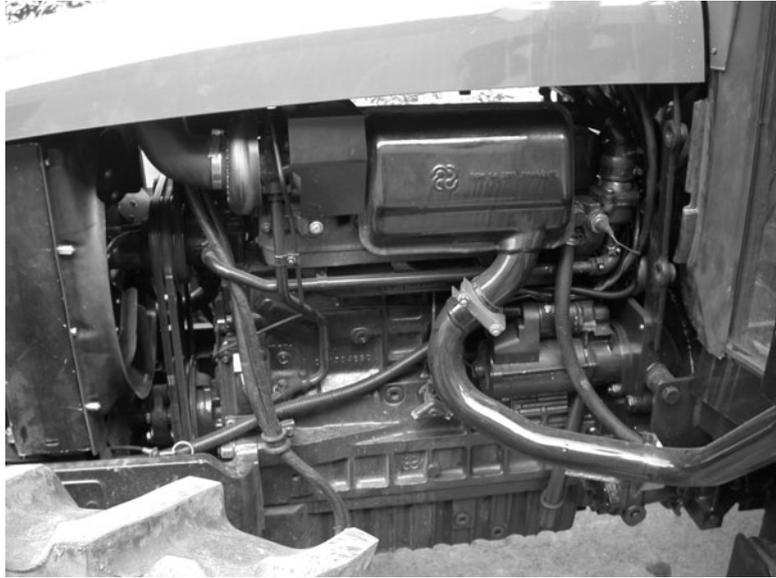
Compartiment moteur - côté gauche (version 4 cylindres avec turbocompresseur))
