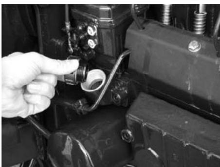
Contrôlez le niveau du liquide de refroidissement du moteur.
