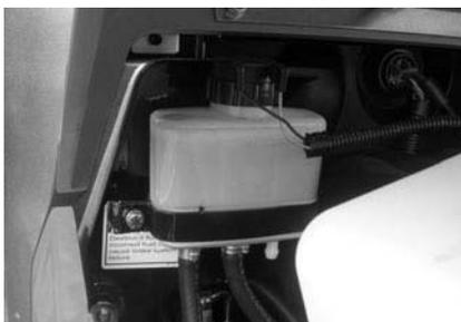
Avertissement : Pour les tracteurs sans inverseur hydraulique, le réservoir de l'huile est le même que celui qui est utilisé pour la commande d'embrayage.
