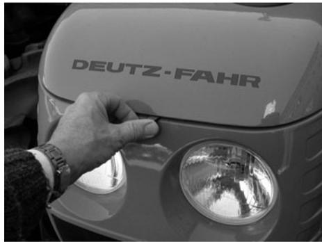
Pressez la commande de déblocage placée à l'avant et le capot se lèvera automatiquement.
