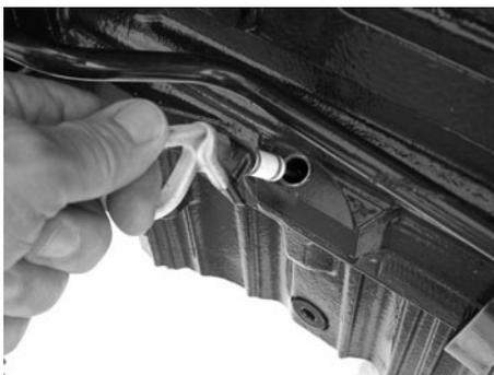
Si nécessaire, faites l'appoint d'huile. N'oubliez pas de remettre en place le bouchon de remplissage.
