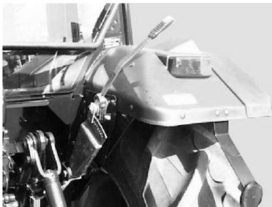
**REMARQUE: DANS LE CAS DE MANOEUVRE DE MONTÉE MANUELLE PAR L'ACTION SUR LE BOUTON SITUÉ SUR LE DISTRIBUTEUR HYDRAULIQUE, ÉVITEZ IMPÉRATIVEMENT D'ATTEINDRE LA HAUTEUR DE MONTÉE MAXI ET MANOEUVREZ TOUJOURS À BAS RÉGIME MOTEUR.**
