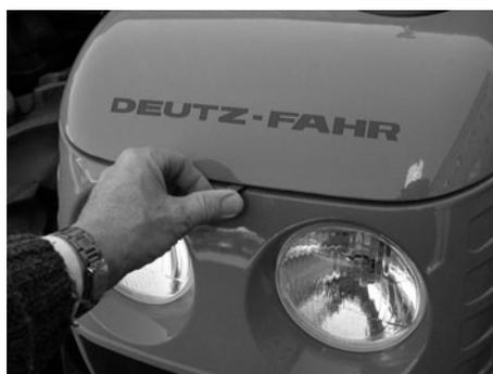
Pour ouvrir le capot, appuyez sur la bouton situé sur la face avant du capot et lever ensuite le capot jusqu'à la verticale; dégager ensuite la béquille et la placer dans son ancrage.
